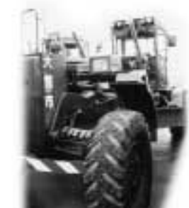
圧雪やわだちを削りながら左側に掃き出す除雪グレーダ。小回りは効かないけれど高速。
