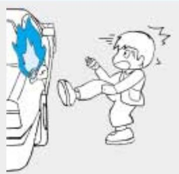
顧客に自ら給油などをさせる給油取扱所（セルフスタンド）で平成13年から14年にかけて全国で火災が5件発生しています。その原因は、人体に帯電していた静電気が給油口のキャップをゆるめた瞬間、キャップ付近の車体金属部分に放電し、給油口からでたガソリン蒸気に引火したものです。
