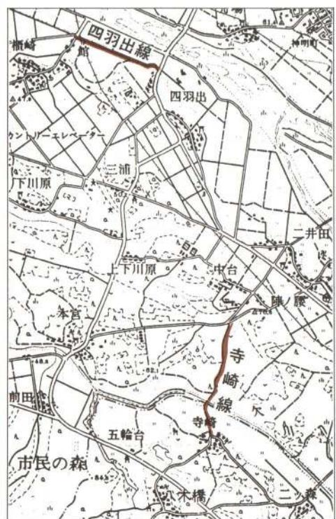
四羽出線は、既設農道の幅員が狭く大型農機等の通行が困難であったことから、その拡幅改良を行ったものです。県道大館鷹巣線・館地区から水田地帯を直進して、市道大館比内線・下四羽出地区を結ぶ全長九七一メートル
