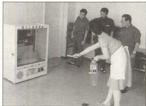
消火器による初期消火を訓練するための消火マスター。超音波で炎(布製)を鎮火します。
