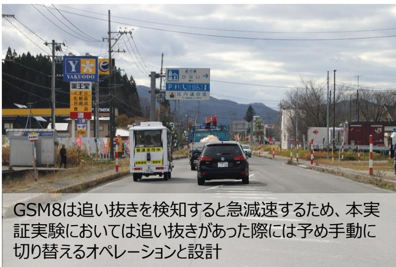
GSM8は追い抜きを検知すると急減速するため、本実証実験においては追い抜きがあった際には予め手動に切り替えるオペレーションと設計
