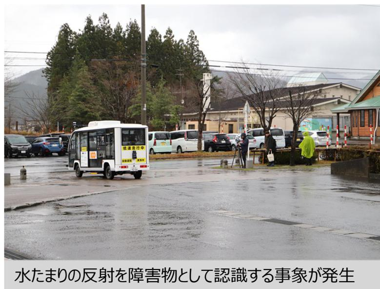
水たまりの反射を障害物として認識する事象が発生
