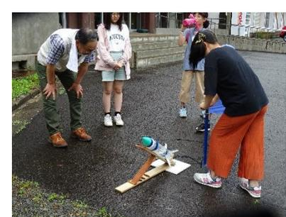
7月 1 日(土) 水ロケット製作は希望者が多く、倍率 2 倍以上でした。人数制限(4 名)は来年度の課題です。自作ロケットは、水ロケット内に入れた空気量で自然発射します。空気入れ回数 15回以内で発射し、飛行距離は18mほどでした。勢いの良かったロケットは、通路左側の樹木の上を飛行しました。
