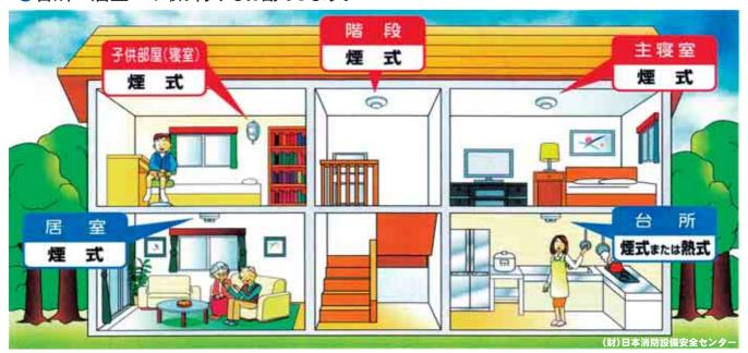
取り付け方法や取り付け位置などを取扱説明書で確認してから、正しく設置してください。
