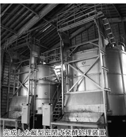
完成した縦型密閉式発酵処理装置
