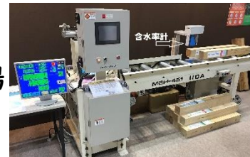
写真2 ヤング率の測定機※2本の製材の上にある機械が含水率計 (写真:林 知行 氏 提供)
