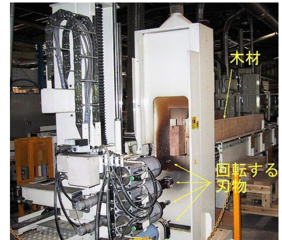
写真3 プレカット加工機のドリル ※先端に特殊な刃物が付いています (写真:林 知行 氏 提供)
