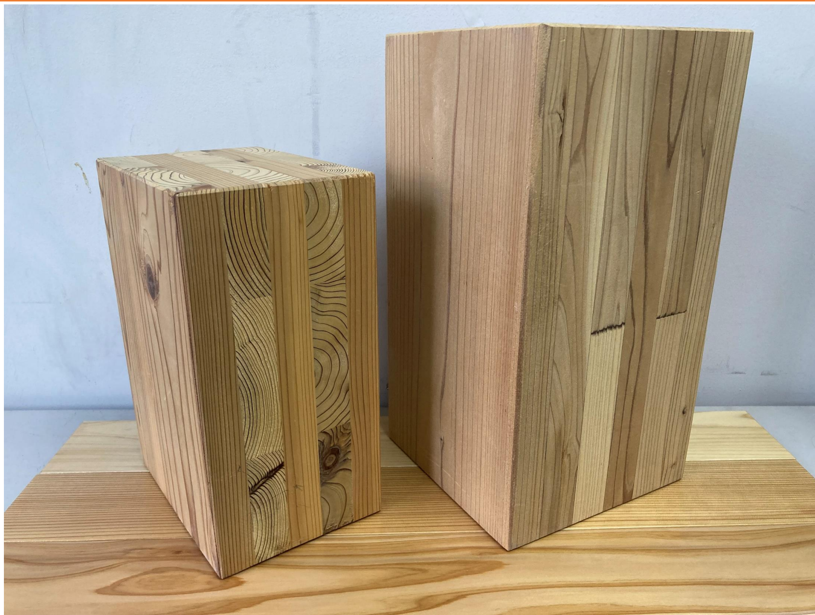
CLT（左、提供：一般社団法人日本CLT協会）と集成材（右、提供：ティンバラム株）のサンプル
