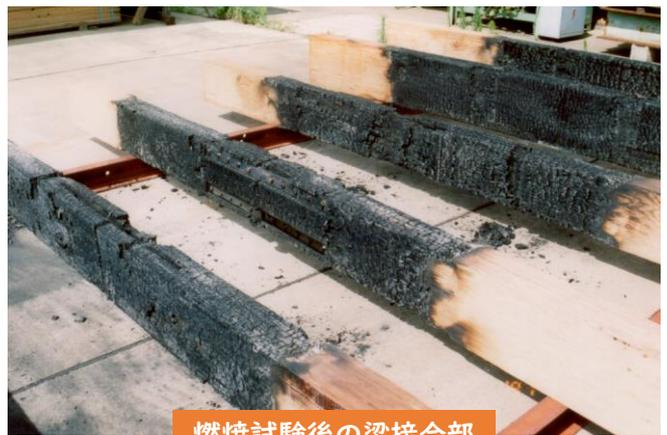
燃焼試験後の梁接合部
