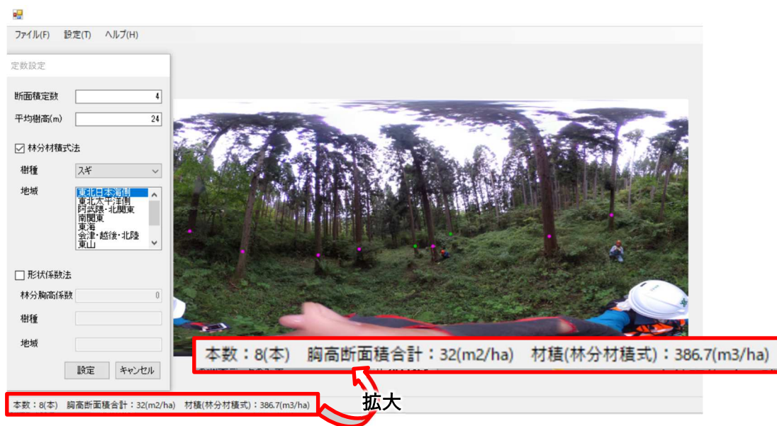
図 2-10 全天球写真ビッターリッヒ法で計測した材積
