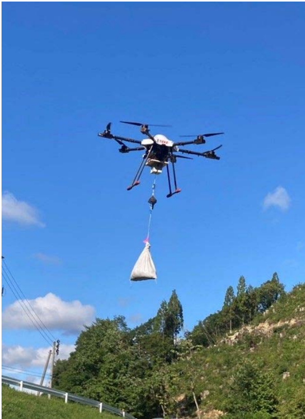
図-10 吊荷の運搬
