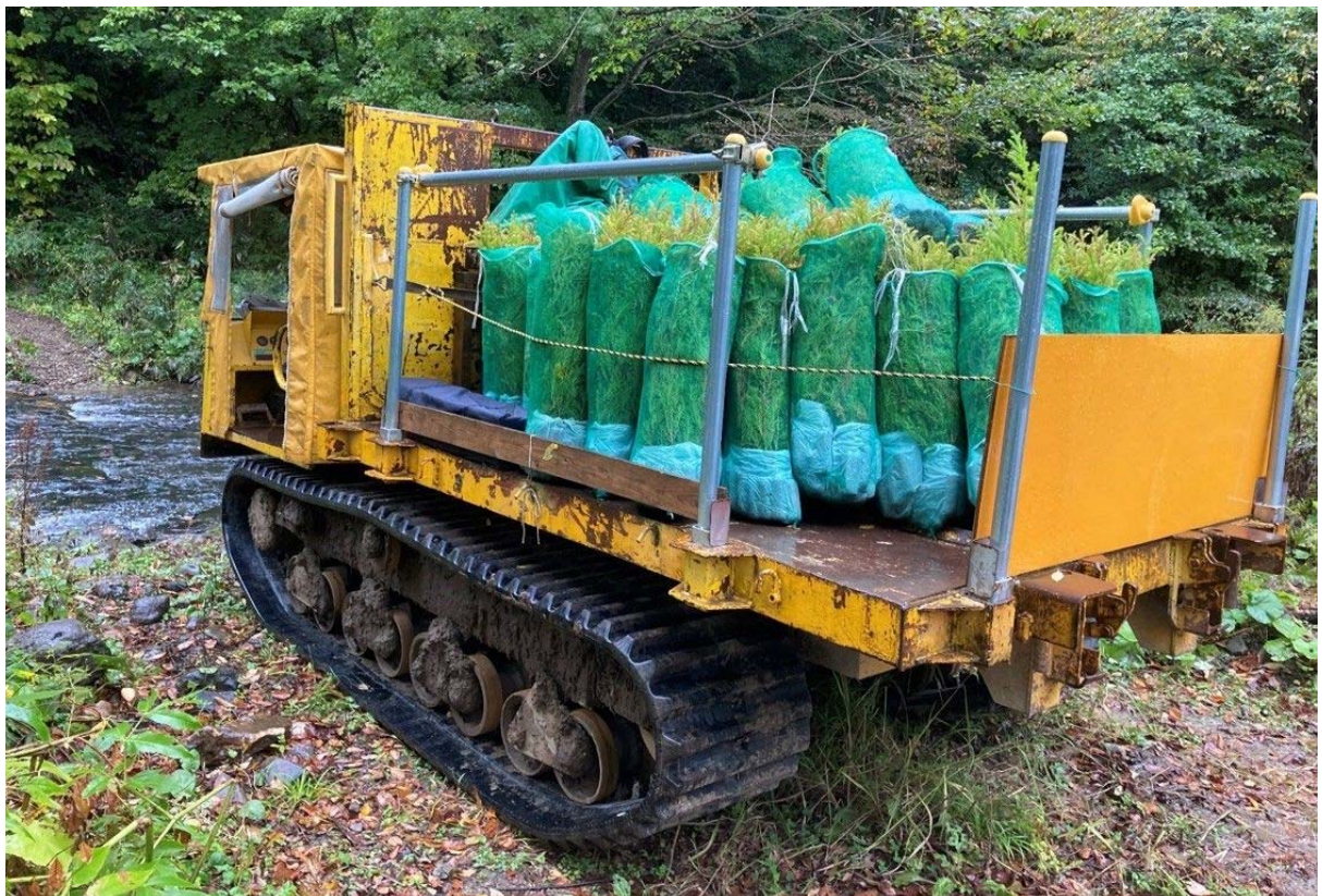
図-16 林内作業車（4 tクラス）、スギコンテナ苗55袋（2,750本）積込
