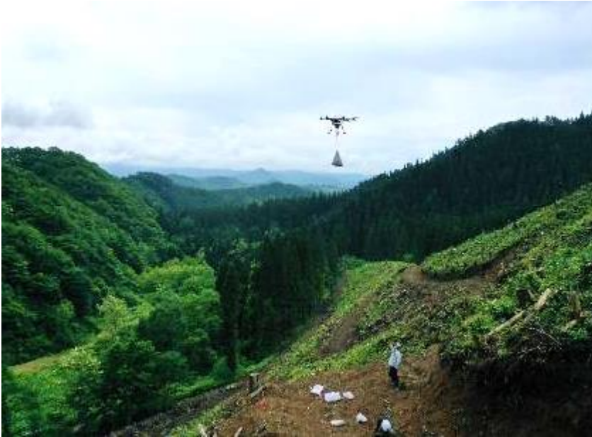
図-9 吊荷の運搬
