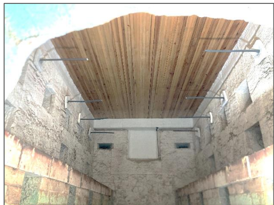
防火試験 炉の様子
