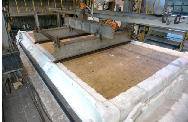
DLT試験体 設置状況
