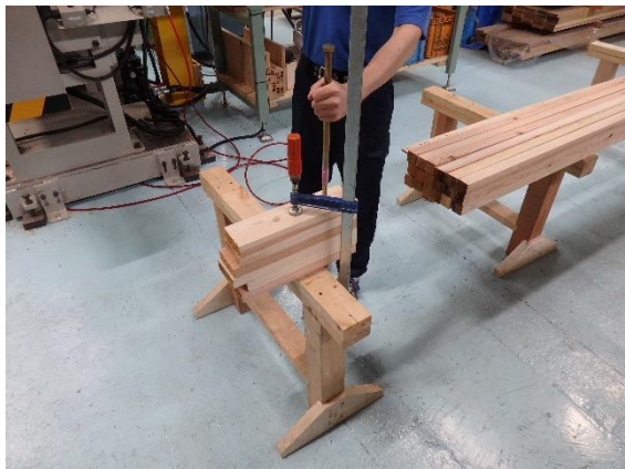
鉄のボルトで木ダボを押し出す様子。
