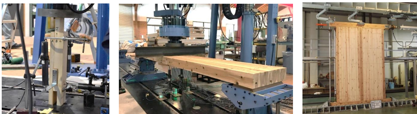
①ダボのせん断強度試験 ②床の曲げ強度試験 ③壁の面内せん断強度試験
